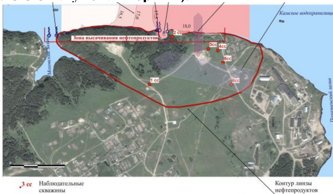
Схема загрязнения гидросферы в районе Полазенского месторождения нефти
